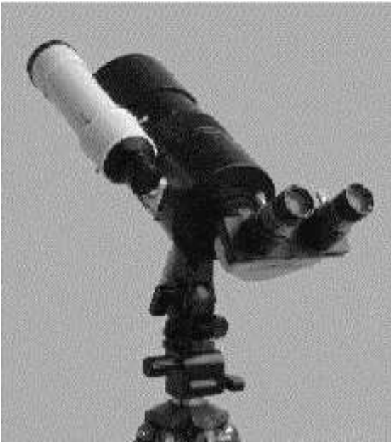
Bild 3: Der Baader 60 Grad Binokularansatz mit zwei 25mm-Plössl-Okularen an der "Russentonne"
