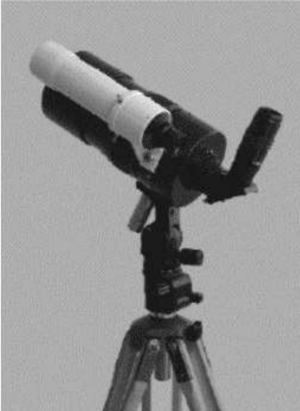
Bild 1: Die Russentonne mit Sucher, Zenitprima und 40mm-Plössl-Okular auf azimuthaler Montierung und Berlebach-Stativ
